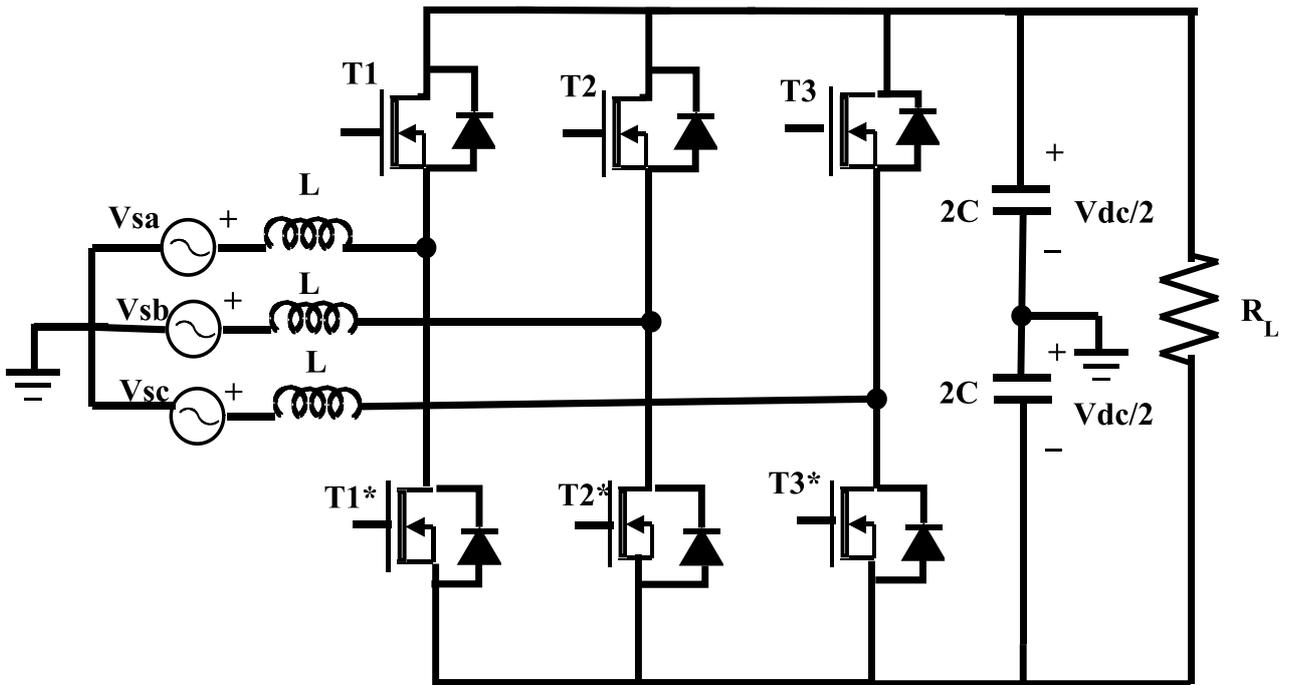
Figure 2. Three Phase PWM Rectifier
