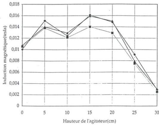
**Figure 11 :** Variation of the magnétique induction (B) par rapport à la hauteur de l'agitateur
