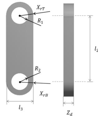
Fig. 7 Link design parameters
