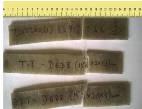
**Fig.8 Tensile Test**
