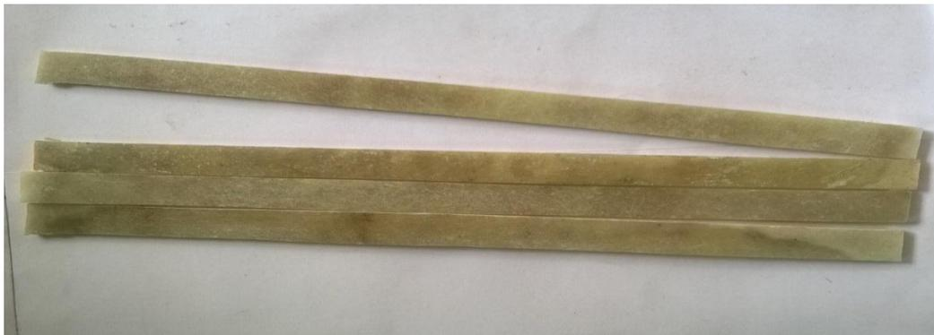
**Fig. 5 ASTM-D7264 Specimen**
