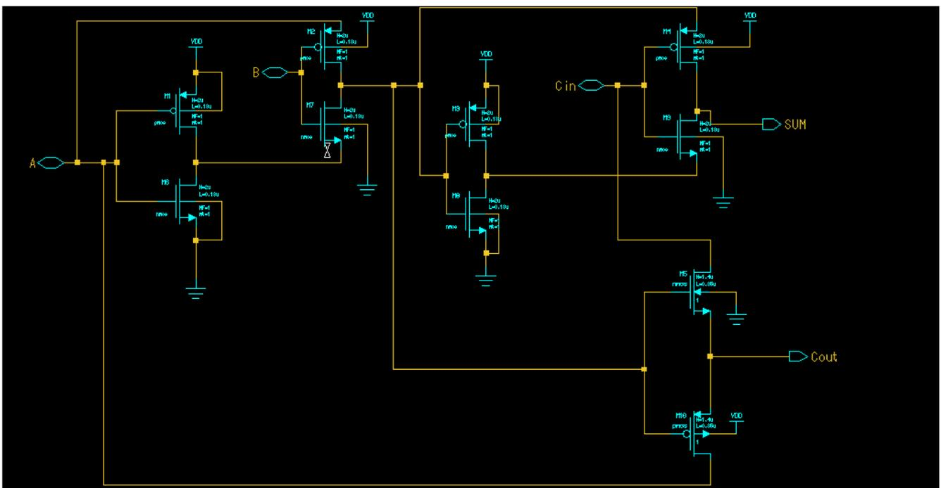
**Fig (3). SERF FA Circuit**
