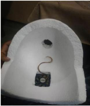
Figure 5: Micro fan assembly
