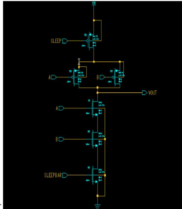
Fig. 2. NAND using MTCMOS
