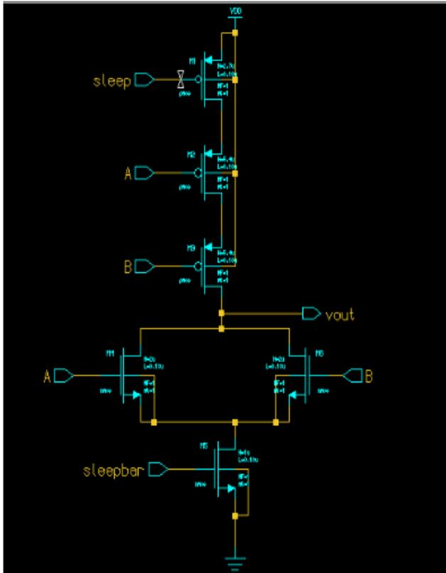
Fig. 3. NOR using MTCMOS
