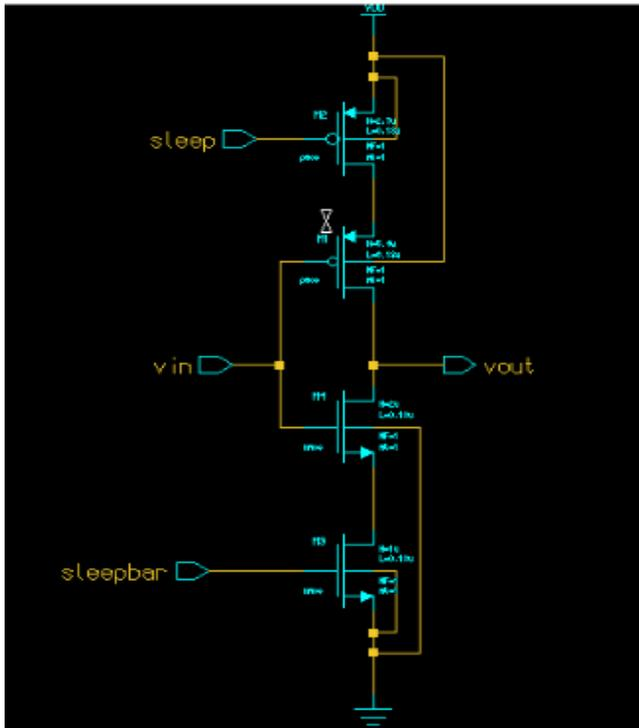
Fig. 1. INVERTER using MTCMOS
