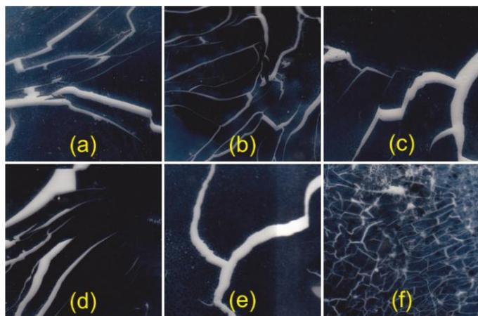
**Figure 3.** PSRM PEDOT:PSS Films (a) 1 mL, (b) 2 mL, (c) 3 mL, (d) 4 mL, (e) 5 mL, and (f) SVM for 30 min
