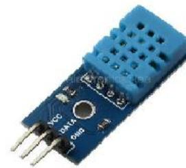
**Figure 4:** DHT11 sensor
