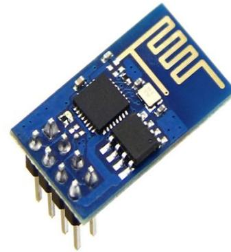
**Figure 8:** ESP8266 Wi-Fi module
